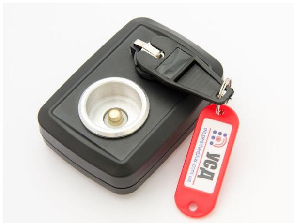
Рисунок 3.1 - установка УСД в адаптер
